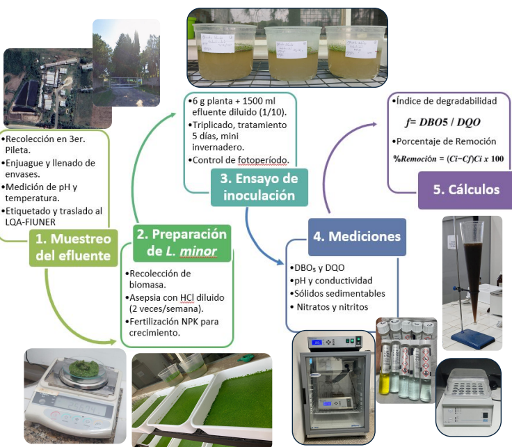
Figura 1. Diagrama de flujo del procedimiento experimental para la fitorremediación de efluentes porcinos con lenteja de agua. Se describen las etapas de muestreo, preparación de la planta, ensayo de inoculación, mediciones de parámetros fisico-químicos y cálculos de degradabilidad y remoción.
